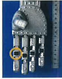
ロボットハンド用超薄型フレキシブル触覚センサ
