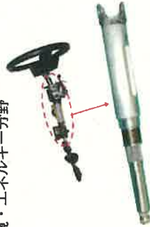
従来品に比べ軽量化・低コスト化を実現したアルミニウム製ステアリングシャフト
