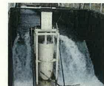
低落差(1m)でも効率的な発電可能なマイクロ水力発電機
