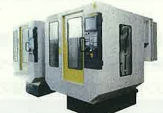
CNCドリリングマシン (3次元CADデータをもとに、アルミや樹脂を切削して模型を製作できる設備)
