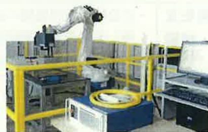
ファイバーレーザ高速微細加工装置 金属表面を高速で精密に溶融、除去、成型する装置
