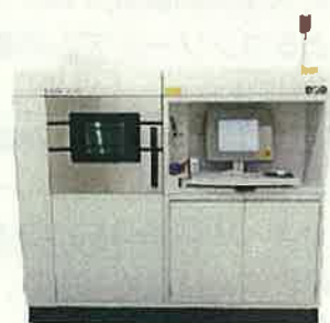
金属積層造形システム 3次元立体形状データに基づき、金属立体形状を作製する装置
