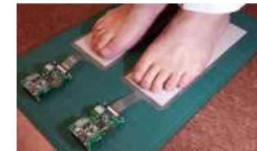
足裏の荷重分布を測る シート状圧力センサ
