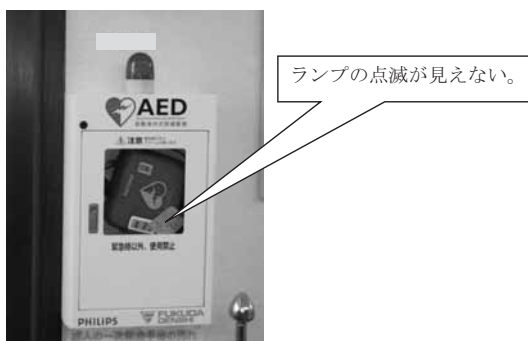
写真-4 収納箱の外からインジケータの表示を確認できない例 (消耗品交換期限が書かれた紙片で表示が隠れている)
